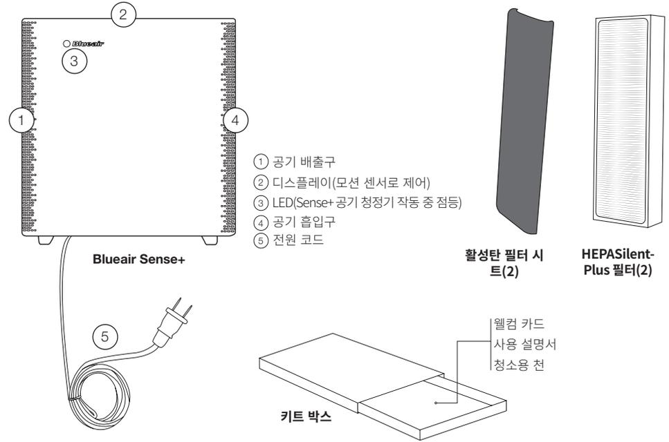
Sense+ 공기 청정기에는 세계 최고 수준의 첨단 무소음 필터 시스템인 특허 받은 Blueair HEPASilentPlus가 포함되어 있습니다. 이 제품은 기계식 여과와 정전식 여과를 결합한 혁명적인 제품입니다. 공기가 공기 청정기 안으로 흡입되면 공기 중에 있는 대량의 입자와 유해 가스가 1차 필터 카트리지에 걸러집니다. 공기가 이온실로 들어가면 기계적으로 걸러지지 않은 입자에 음이온이 대전되어 2차 필터 카트리지에 양이온이 대전된 섬유에 견인되어 걸러지게 됩니다. 사실상 오염물질이 모두 제거되고 정화된 공기가 해당 공간에 재순환됩니다.
