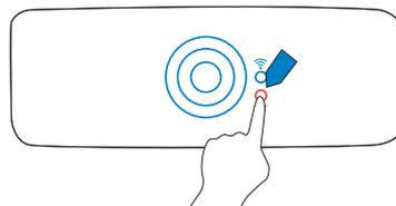
7. 插上电源，将机器扶正放置，轻按控制面板上红色滤网提示灯。大约10秒后，红灯消失现在您的Blueair又可以给您带来洁净健康的空气了！
