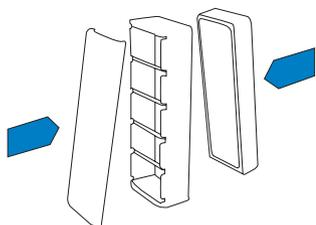
4. 新しい交換用フィルターと脱臭シートを取り付けます。フィルター、フィルターケースに貼られている「空気の流れ」シールの矢印の向きを必ず揃えてください。
