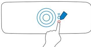
7. 差込プラグを電源コンセントに差し込み、本体を立てたのち、天面中央部で手をスライドさせ電源を入れます。赤く点灯した「Filter」ランプを約10秒間長押しすると、ランプは消灯します。
