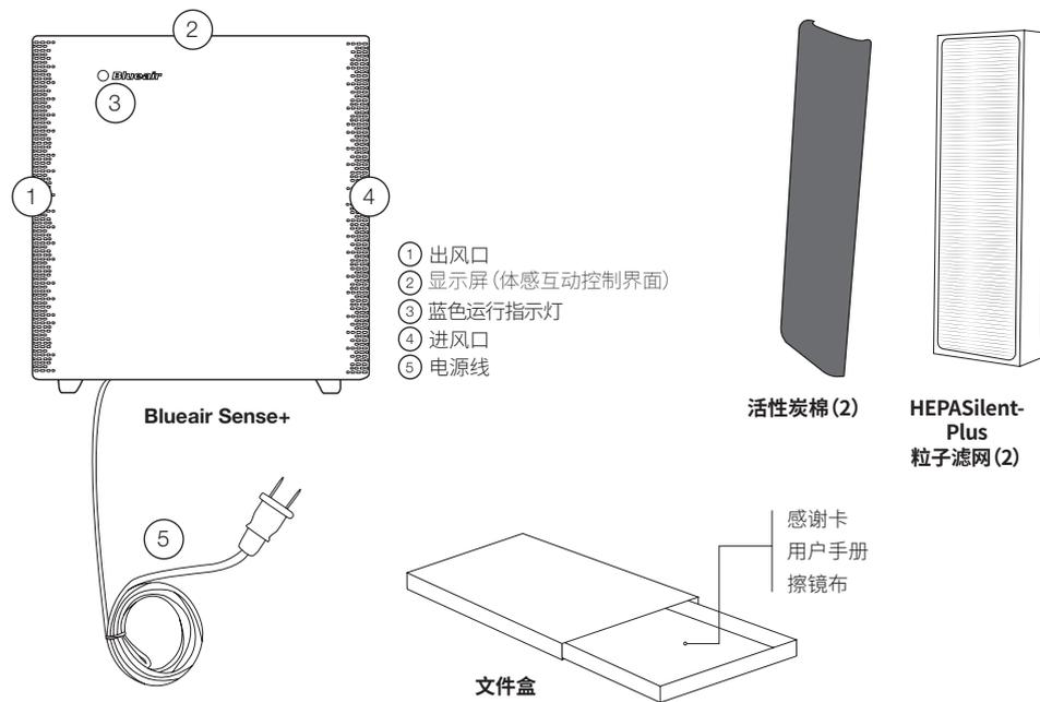
Blueair Sense+拥有Blueair专利HEPASilentPlus多层渐进式过滤技术, 是结合静电吸附和滤网过滤的双重技术。空气中的微粒、细菌、霉菌及宠物毛发等通过超静音电机吸入Sense+空气净化器, 稍大的室内空气污染物会被前置滤网拦截掉, 其它空气污染物通过空气净化器的离子室带上静电, 带电污染物就能轻松地吸附到Blueair独有滤网上。过滤后的洁净空气以每小时5次的速率全屋循环。
