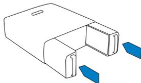
6. フィルターケースを本体に差し込みます。本体底面、フィルターケースに貼られている「空気の流れ」シールの矢印の向きを必ず揃えてください。
