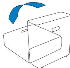
1. 電源を切り、差し込みプラグを電源コンセントから抜きます。柔らかい布などを敷き、ハンドルを持ちながら、ハンドル面が上になるようにゆっくりと横に倒します。
