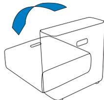
1. 关机，拔出电源插头，将机器侧身放置使背面朝上。(可将机器放在柔软的毯子上)
