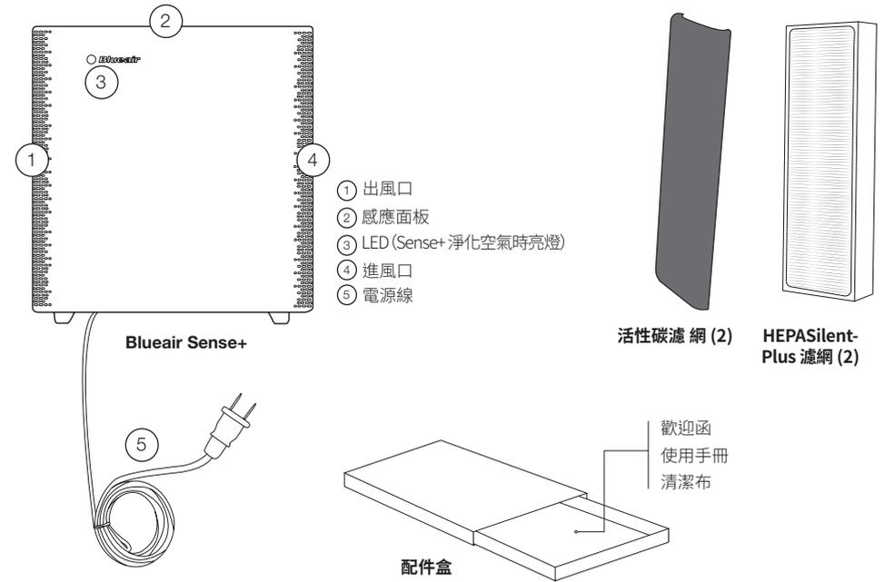
Sense+ 配有 Blueair 的專利裝置 HEPASilentPlus，這是目前世界上最先進的無聲過濾系統。它革命性地組合了物理過濾和靜電過濾方法。空氣被吸入清淨機時，空氣中較大的顆粒物和氣態污染物在第一層過濾匣即被捕獲。接下來，空氣會通過一個離子室，在此未被物理過濾捕獲的顆粒物會帶上負離子，然後在第二層過濾匣中被帶有相反電極的離子纖維吸附捕獲。隨後，室內流通的即是真正純淨無污染之空氣。
